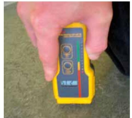
Tendenzielle Feuchtemessung mit einem Handgerät.
