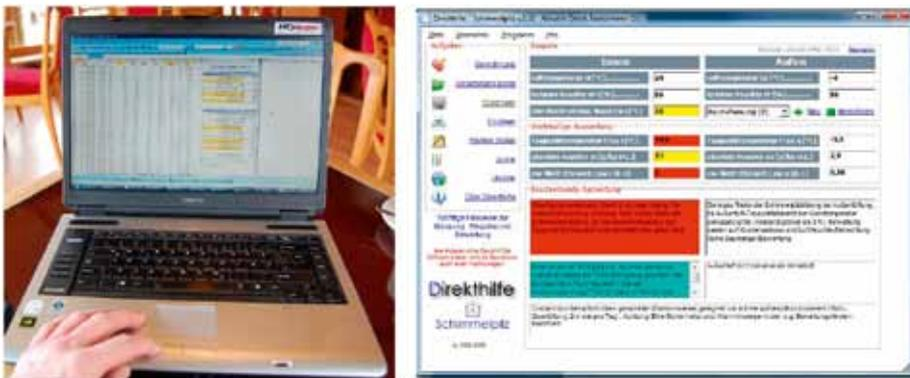
Software-Maske zur Unterstützung von Luftfeuchtemessungen. Nach Eingabe werden von der Software nicht nur Werte ermittelt, sondern auch klare, mit Warnfarben markierte Texthinweise ausgegeben.
