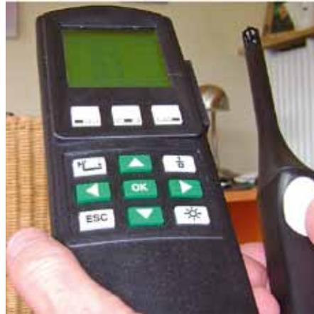
Luftfeuchtemessung mit einem Hygrometer.
